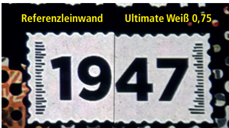
Im A/B-Vergleich mit unserer Referenzleinwand (links) ist zu sehen, dass die Ultimate Weiß 0,75 (rechts) den Film rund 19 Prozent dunkler abbildet.
