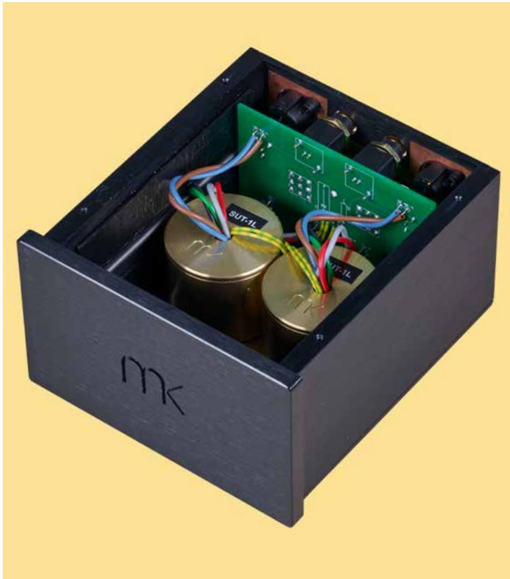
Links: Die bereits mit Mu-Metall geschützten Übertrager des SUT-1L stecken zusätzlich in schirmenden Messingkapseln. Rechts: Das externe Netzteil des MM-PH-Amp kommt mit wenigen, aber hochwertigen Bauteilen aus.
