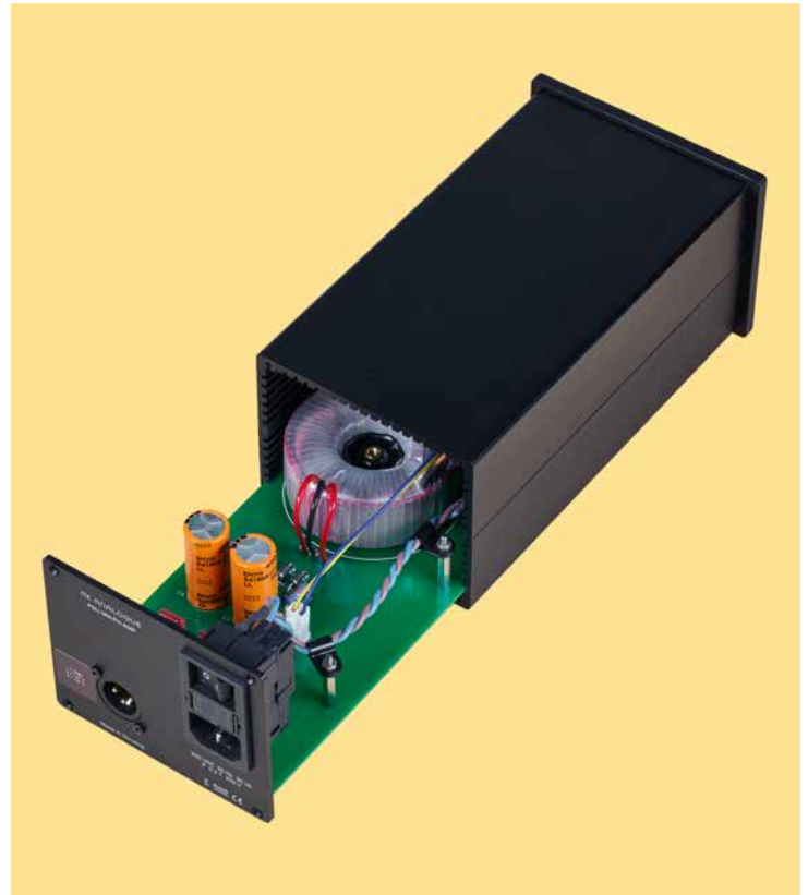
Links: Die bereits mit Mu-Metall geschützten Übertrager des SUT-1L stecken zusätzlich in schirmenden Messingkapseln. Rechts: Das externe Netzteil des MM-PH-Amp kommt mit wenigen, aber hochwertigen Bauteilen aus.
